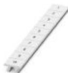
Zackband, Streifen, weiß, beschriftet, beschriftbar mit: CMS-P1-PLOTTER, quer bedruckt: fortlaufende Zahlen 1 ... 10, 11 ... 20 usw. bis 91 ... 100, Montageart: verrasten in hoher Schildchennut, für Klemmenbreite: 8,2 mm, Schriftfeldgröße: 10,5 x 8,15 mm, Anzahl der Einzelschilder: 10
