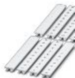
Zackband, Streifen, weiß, beschriftet, beschriftbar mit: CMS-P1-PLOTTER, längs bedruckt: fortlaufende Zahlen 1 ... 10, 11 ... 20 usw. bis 91 ... 100, Montageart: verrasten in hoher Schildchennut, für Klemmenbreite: 8,2 mm, Schriftfeldgröße: 10,5 x 8,15 mm, Anzahl der Einzelschilder: 10
