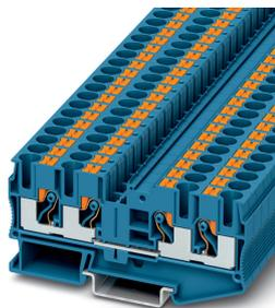
Durchgangsklemme, Nennspannung: 1000 V, Nennstrom: 41 A, Anschlussart: Push-in-Anschluss, Anzahl der Anschlüsse: 4, Querschnitt: 0,5 mm<sup>2</sup> - 10 mm<sup>2</sup>, AWG: 20 - 8, Breite: 8,2 mm, Höhe: 42,2 mm, Farbe: blau, Montageart: NS 35/7,5, NS 35/15
