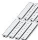
Marker für Klemmen, Streifen, weiß, beschriftet, beschriftbar mit: CMS-P1-PLOTTER, längs: L1, L2, L3, N, PE, L1, L2, L3, N, PE, Montageart: verrasten in hoher Schildchennut, für Klemmenbreite: 8,2 mm, Schriftfeldgröße: 10,5 x 8,15 mm, Anzahl der Einzelschilder: 10
