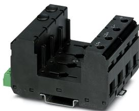
Basiselement für Überspannungsableiter, für isolierte Gleichspannungssysteme 1000 V DC, für Tragschienenmontage, 4-poliges Basiselement mit Fernmeldekontakt, zum Schutz von zwei parallelen Strings / MPP-Tracker.
