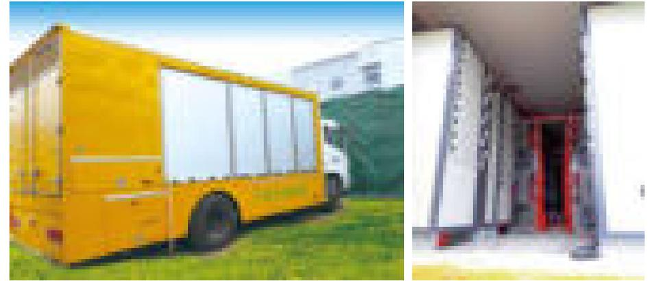
► Mobiles Energiespeicherfahrzeug der Firma OptimumNano Energy
